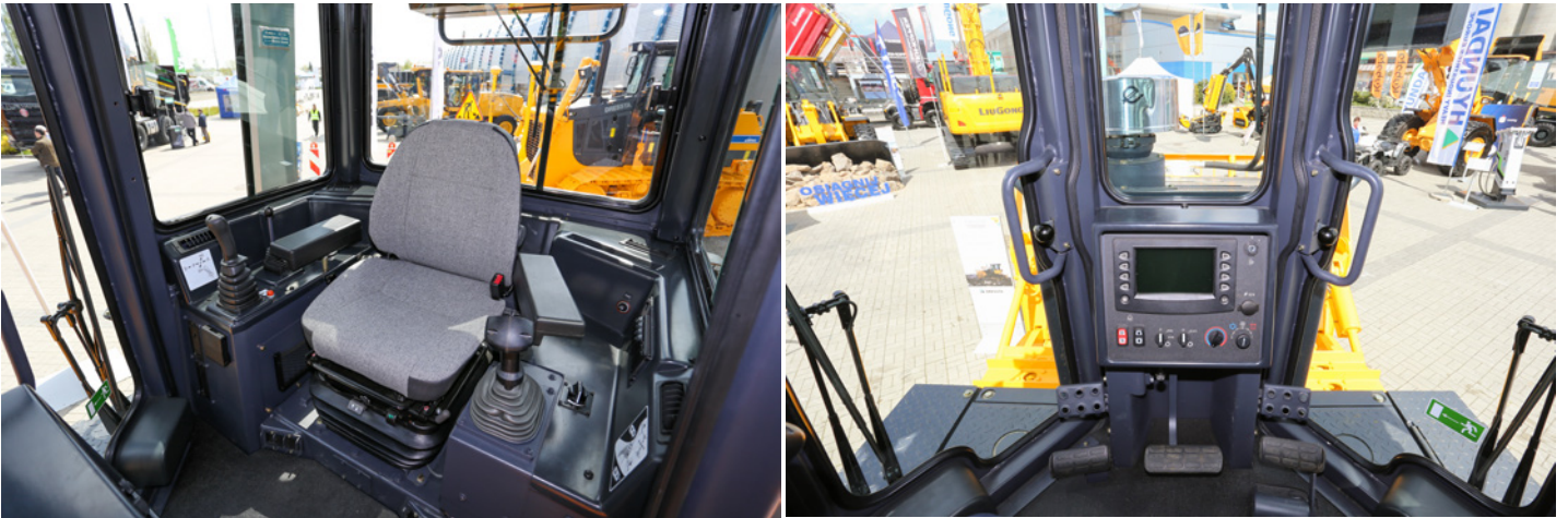
W spycharkach Dressta kabina jest elastycznie zamocowana do podwozia, co ogranicza drgania przenoszone na fotel operatora. Duże powierzchnie przeszklone i ukośny profil pokrywy silnika zapewniają znakomitą widoczność we wszystkich kierunkach.
