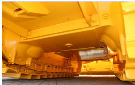
Spód maszyny jest zabezpieczony solidnymi osłonami, które chronią niewralgiczne podzespoły przed uszkodzeniem i zanieczyszczeniami. Osłona z przodu spycharki została zamocowana na zawiasach, opuszcza i podnosi się ją za pomocą elektrycznej wyciągarki.
